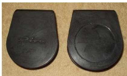
Articolo 4573 Patelle in gomma nera da montare sui terminali dei tubi di scarico Ø 70 mm. (Riva) o 75 mm. (Offshorer 27'-30') onde evitare un ritorno di acqua in caso di retromarcia o arresto rapido dello scafo.
